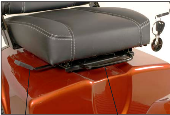
Utløserhåndtak for setedreining. Utløserhåndtak for sete frem/tilbake.
