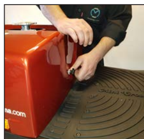
Løsne fingerskruene og løft bort bakskjermen.
