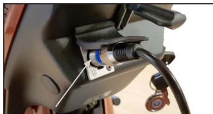
Ladestik forbindes til 3-polet stik på styrstammen. Ladestikket er placeret under beskyttelsespladen.
