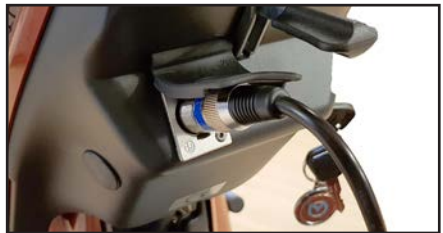
Ladestøpslet kobles til 3-polet kontakt på styrestammen. Ladekontakten er plassert under beskyttelsesplaten.
