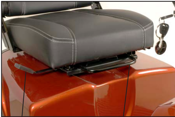
Utløserhåndtak for setedreining. Utløserhåndtak for sete frem/tilbake.
