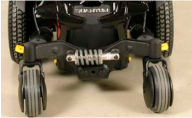
Normal posisjon for kjøring - skjøvet opp
