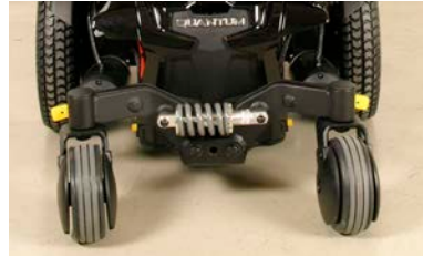
Posisjon for frikobling - skjøvet ned
