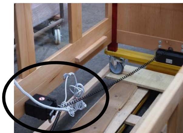
Fig. 4: Strekkavlaster og styreboks festet på montasjeplaten
