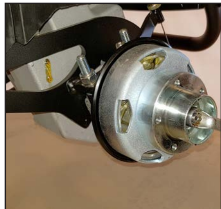
Demontere opphengingen. (17mm nøkkel)
