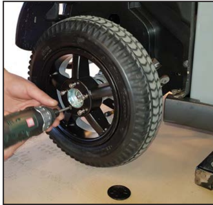
Hev bakenden, så bakhjulet ikke r r underlaget.
