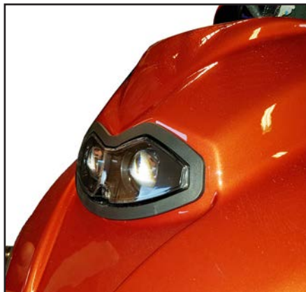
Om fremlampa ikke funker, byttes hele fremlampa.
