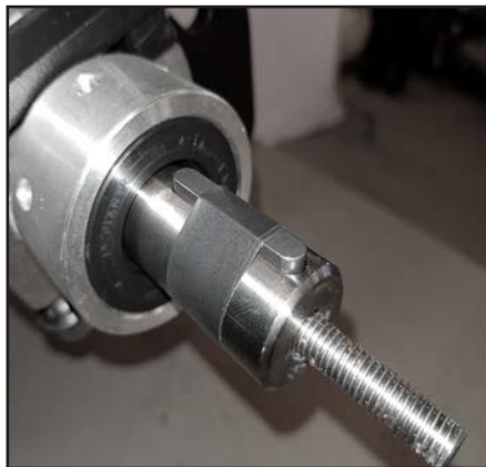
På en ny transaksel sitter kilen fast med tape ved leveranse.
