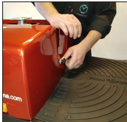
Løsne fingerskruene og løft opp bakskjermen.
