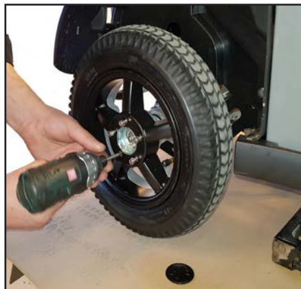
Demontere begge bakhjulene.
