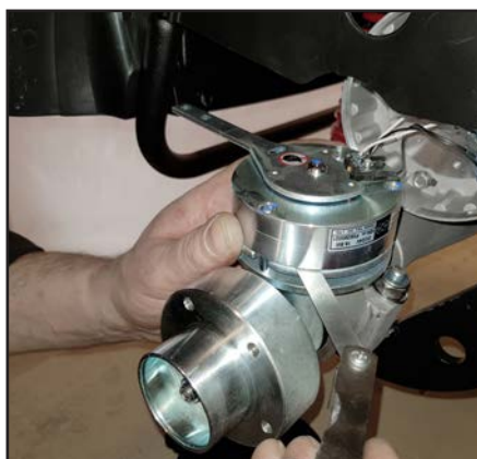
Kontroller avstanden til magneten. Hvis den er st rre enn 0,35 mm, er den sliten og skal erstattes. En ny har en avstand p  0,15 mm.
