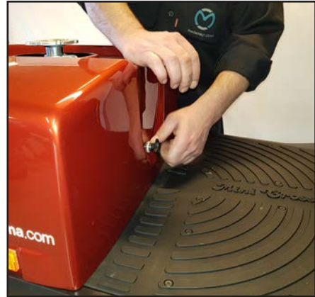
Løsne fingerskruene og løft bort baksjermen.
