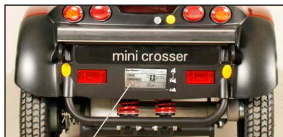
Serienummerskiltets plassering på kjøretøyet.
