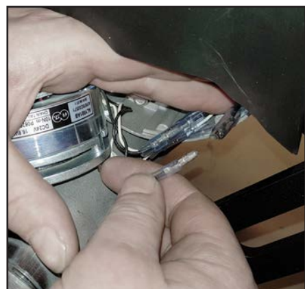
L sne de fire kontaktene og magnetbremsen er ledig.
