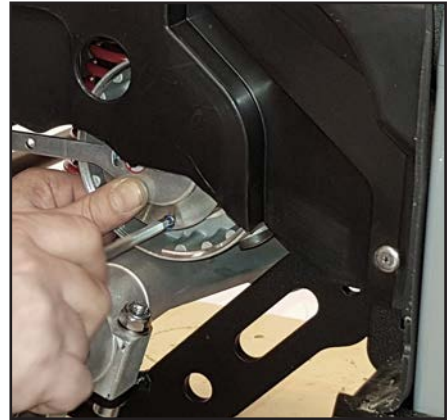
Bruk locktite på skruene ved montering. Spennes med 4Nm. Locktite nr. 2400
