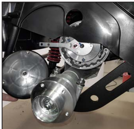
N  kommer man til magnetbremsen.
