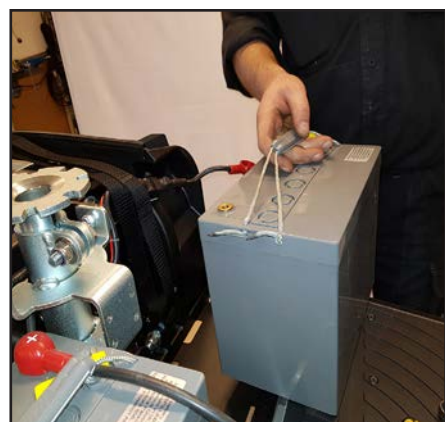
Batteriet er nå fritt og kan byttes. Et nytt monteres i motsatt rekkefølge.
