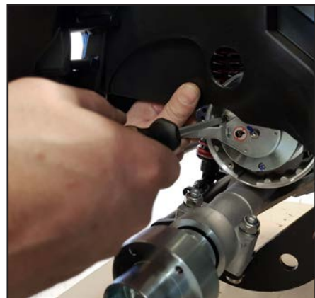
L sne magnetbremsen med de 3 skruene. De har en locktite p  monteringen.
