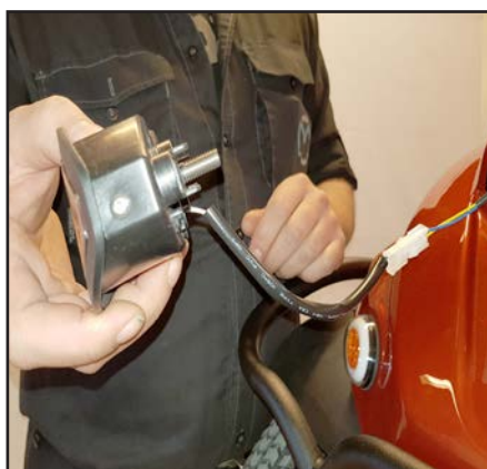
Lampa tas ut, løsne kontakten og lampen er fri.
