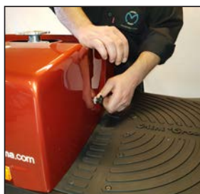
Løsne fingerskruene og løft bort baksjermen.
