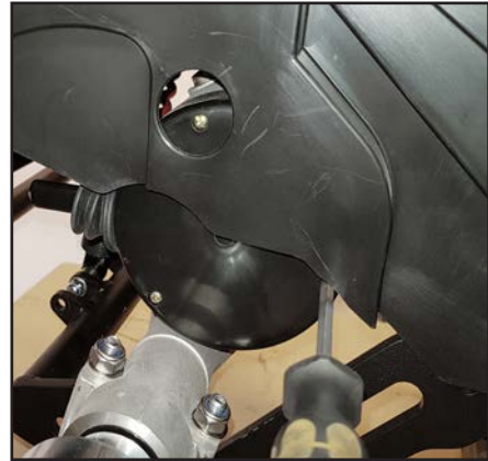
L sne de 3 skruene som holder dekselet.
