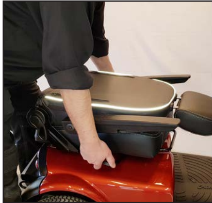
Brett opp armlene og deretter ryggstøtten helt ned. Lås opp setelåsen - snu setet litt og løft det rett opp
