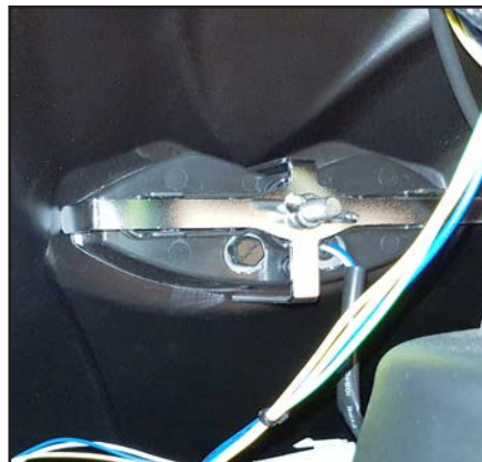
Lampen sitter fast med et beslag på innsiden av skjermen. En enkel fingerskrue holder den på plass. Ta bort skruen.
