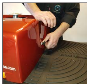
Løsne fingerskruene og løft bort baksjermen.
