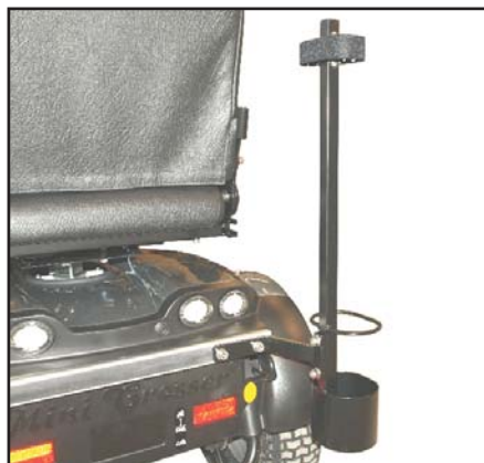
Tilpass listen i lengde. Monter stokkholderen i C-skinnen. Monter proppen igjen.
