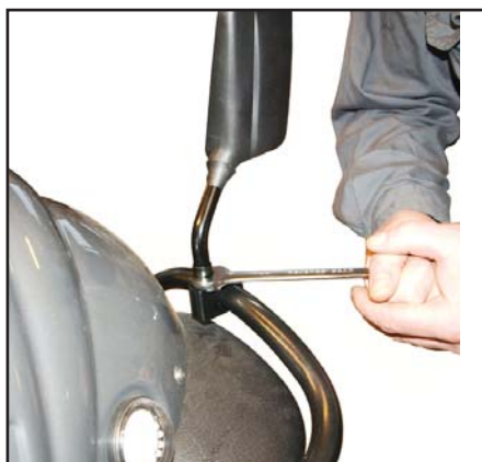
Til slutt settes speilet som ønsket og kontramutteren strammes.
