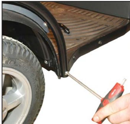
Skru ut skruen og skiven. Ta vare på dem til senere montering.
