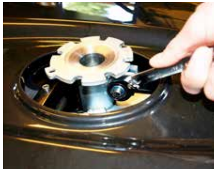
Skru løs låsemutter. Bruk fastnøkkel 17 mm.
