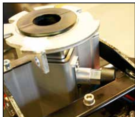
Utløseren trukket ut. Dreii den rundt for å få den til å "hoppe" inn igjen.
