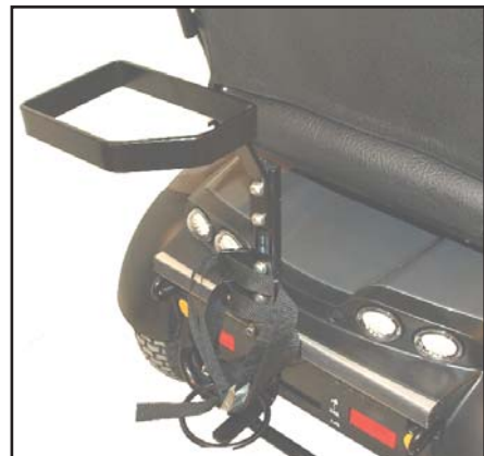
På samme måte monteres holder for oksygenapparat.
