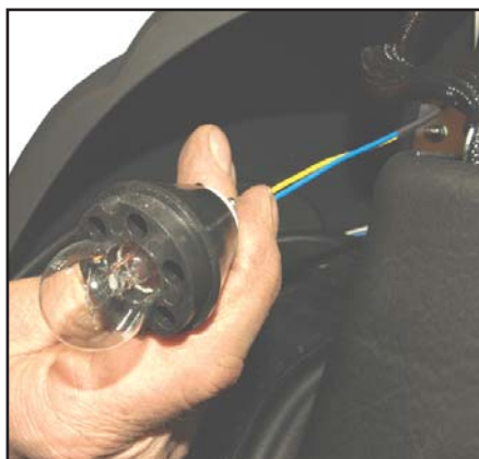
På 4W kan man løsne pæren og trekke den ut til utskifting uten å demontere skjermen.
