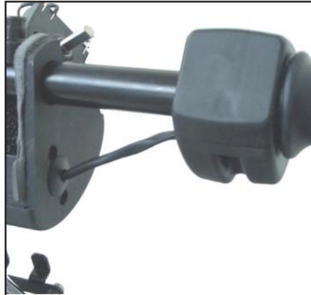
Kontakt og propp monteres i hullet. Husk også å montere de to små proppene igjen.
