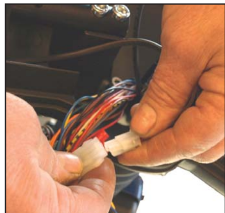
Koble dreiegassen til den 3-polede kontakten der standardpotensiometeret er koblet til.
