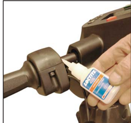
Bruk Loctite 406 med montering av gasshåndtaket.
