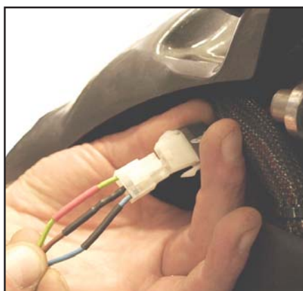
Kabelen til gasspedalen trekkes gjennom hullet og opp ved styrestammen. Den medfølgende kontakten monteres som vist ovenfor. Scooterens kontakt (nr. 4) til gasspedal trekkes frem (ligger under forskjermen) og monteres med gasspedalen.
