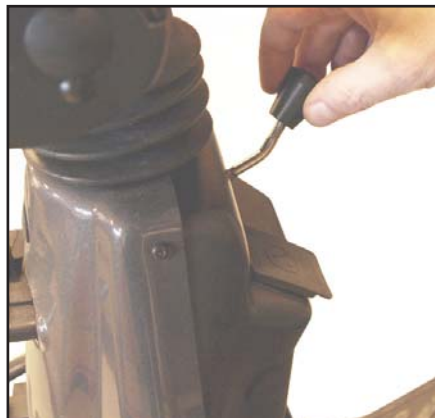
Ta plasthåndtaket av "Utløser for gassfjæring".
