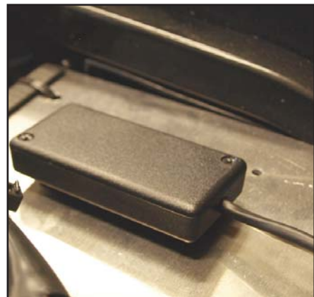
Monteres med borrelås på strømplaten.
