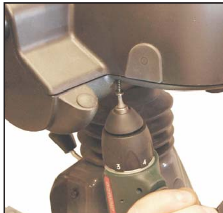
Løsne de fire skruene som holder betjeningspanelet på plass.
