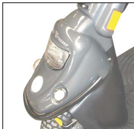
På 3W skal forskjermen demonteres før man skifter pære.
