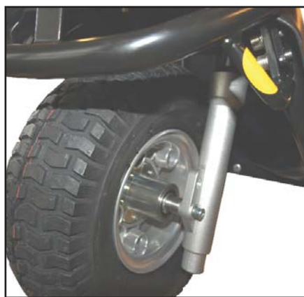
Demonter forhjulet. Se evt. avsnittet om hjulbytte.
