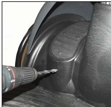
Finn ut hvor gasspedalen skal monteres. Bor et 13 mm hull til kablen fra gasspedalen. Fores med medfølgende gummifôring.
