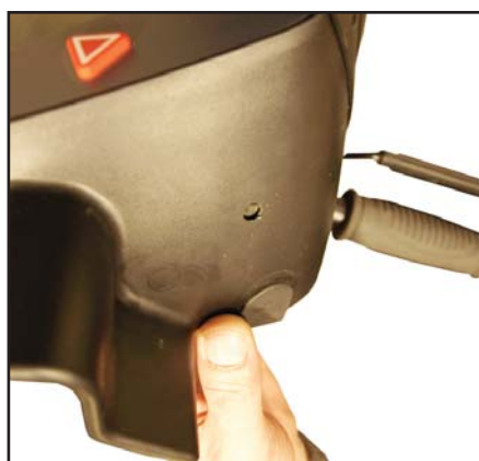
Bor et 6,5 mm hull. Se illustrasjon for plassering.
