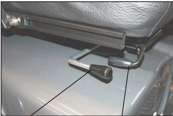
Utløserhåndtak for setedreining. Utløserhåndtak for sete frem/tilbake.
