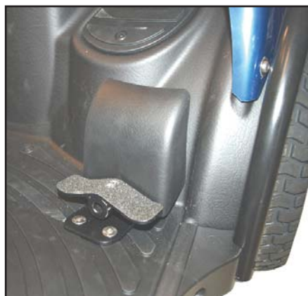
Fodgaspedal til frem og tilbage placeret i højre side.
