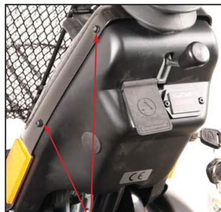
Bagerste plastskærm afmonteres v.h.a. de 6 plastskruer.
