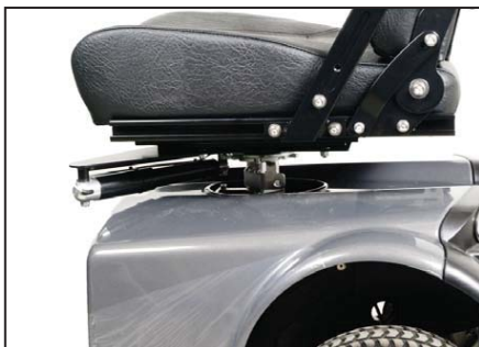
Monter stikket under sædet med stikket fra kontakten. Kontrollér at el-sædet virker som det skal.
