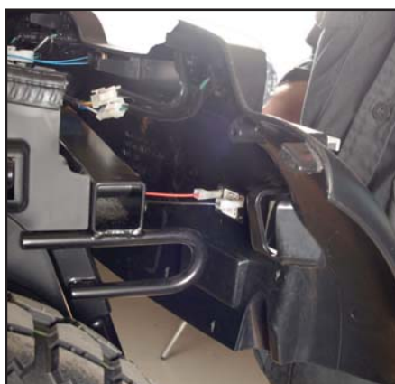
Afmontér bagskærmen. Skil stikkene til lys og blinklys, så bagskærmen er helt fri.
