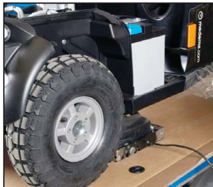
Hæv Mini Crosseren så baghjulene er fri af underlaget.
