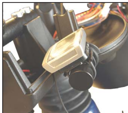
Montér speedometeren på holderen med det medfølgende montagebånd. Montér styringspanelet igen.
