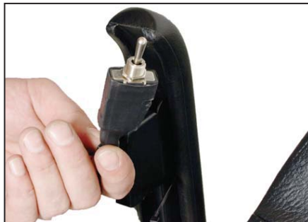
Inden kontakten monteres i boksen, kontrollér da at ned = fremad og op = tilbage.
