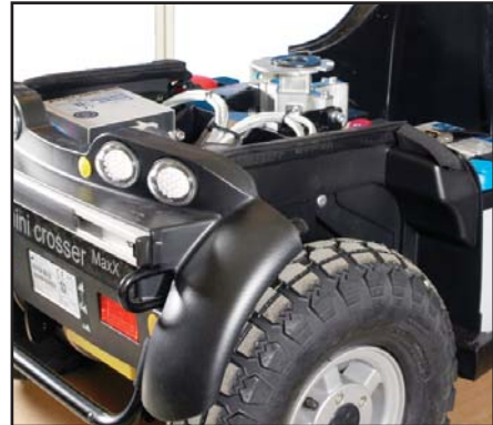
Tag sædet og batterikåben af.
