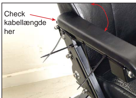
Kablet stripses op. Bemærk: giv nok kabel til at armlænet kan køre uhindret op og ned før der stripses.
