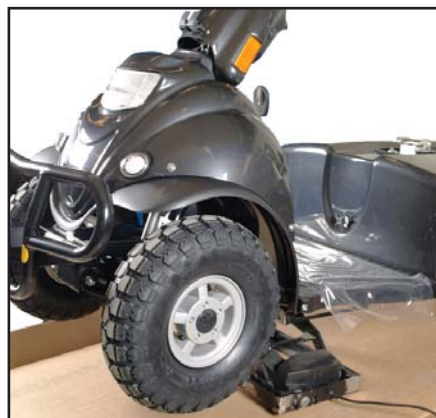
Forenden af Mini Crosseren hæves op så det er muligt at få hænderene helt op under skærmen.
