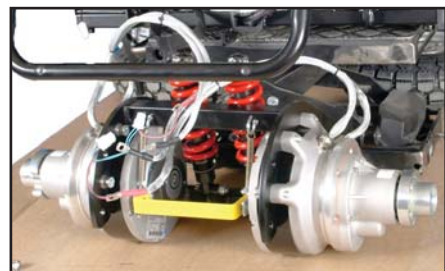
Bagsvinger med begge motorer er nu fri og kan udskiftes.
