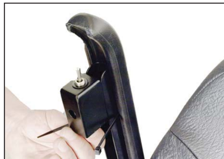
Kontakten monteres med gummibælg og omløber.
