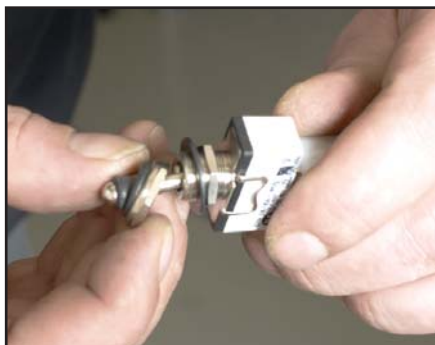
Kontakten skilles så bælgen og møtrikken tages af. Stikket placeres i hullet i styringspanelet. Montér møtrik og bælg igen
