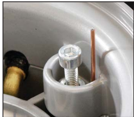
Montér kobberkrogen under skiven.
