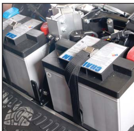
Montér batterierne igen. Kontrollér at baghjulene løber samme vej.
