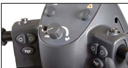
Vær opmærksom på, at kontakten vendes, så den kører hurtig, når kontakten er vippet op og langsom, når kontakten er vippet ned.
