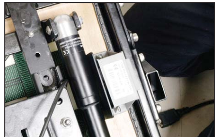
og montér el-boksen på træpladen. Strip ledningerne op.
