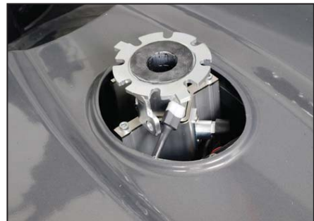
Udskift sæderøret med det medfølgende. Træk lidt op/ ned til sæderøret har fanget et hul.
