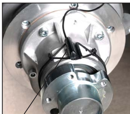
Montér føleren på motorakslen med den store monteringer og 2 strips.
