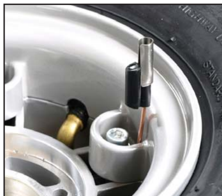
Montér magneten på kobberkrogen.
