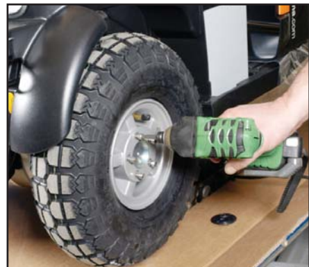
Afmontér højre baghjul ved at løsne de 5 skruer i flangen.
