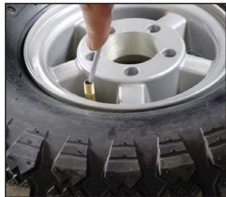
Brug en lille skruetrækker til at lukke noget af luften i dækket ud.
