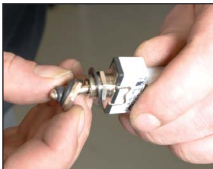
Kontakten skilles så bælggen og møtrikken tages af. Stikket placeres i hullet i styringspanelet. Montér møtrik og bælg igen
