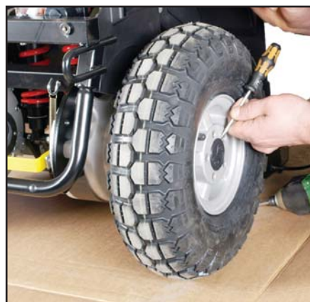
Hæv køretøjet så baghjulene ikke rører underlaget. Afmontér begge baghjul.
