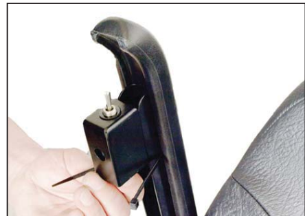
Kontakten monteres med gummibælg og omløber.
