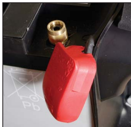
Afmontér + polen på et af batterierne.
