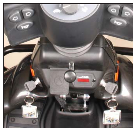
Montér plast skærm igen. Tænd for scooteren og kontrollér (se forrige side).
