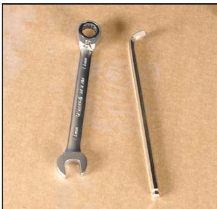
Nødvendigt værktøj. Unbrako nøglen (str. 6) er afkortet for at kunne være der.
