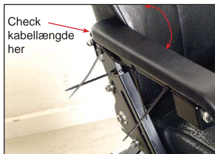
Kablet stripses op. Bemærk: giv nok kabel til at armlænet kan køre uhindret op og ned før der stripses.
