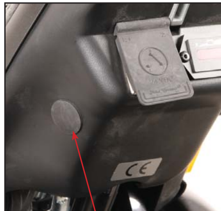
Gummiprop i plast dæksel fjernes.
