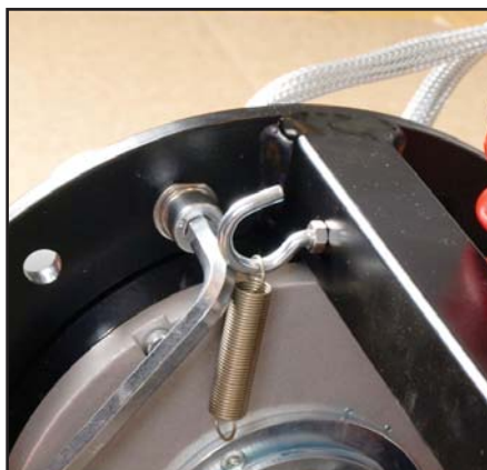
Frikoblingsarmen skrues fri af den motor der skal udskiftes.
