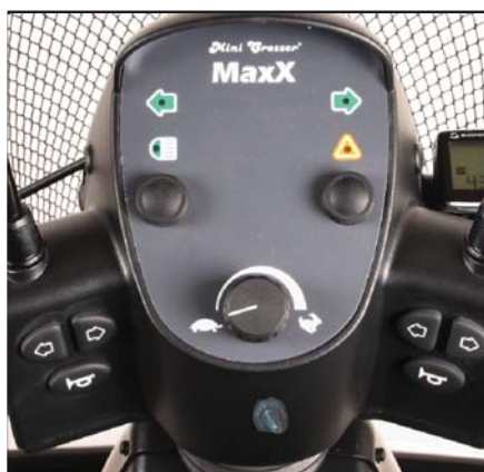
Montér betjeningspanel. Undgå at klemme / strække ledningerne.
