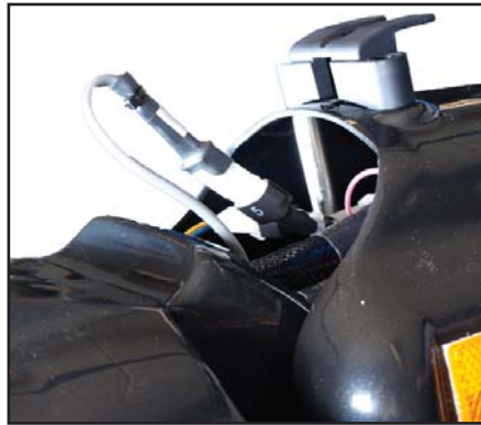
Styrestangen vippes ned. Følerens ledning føres op til stik nr. 5 og tilsluttes.
