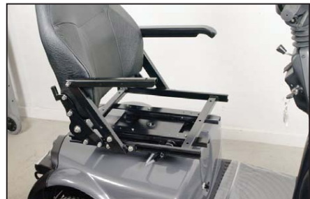
Sæt sædet på køretøjet og forbind kontakten. Kontrollér at sædet kan køre frem/tilbage.
