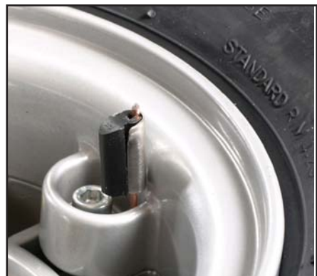
Når hjulet er monteret skal der være ca. 3 mm mellem føleren og magneten.
