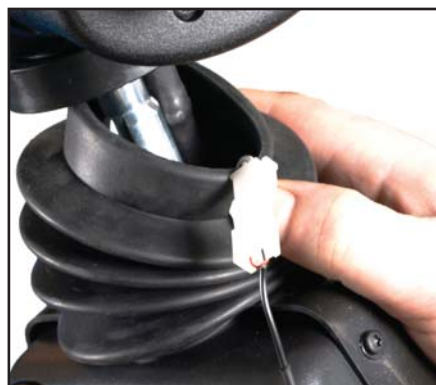
Tilsluttes stikket fra speedometeren. Gem stikket og ledning under bælgen.
