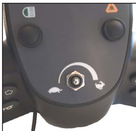
Montér frem / bak kontakt.
