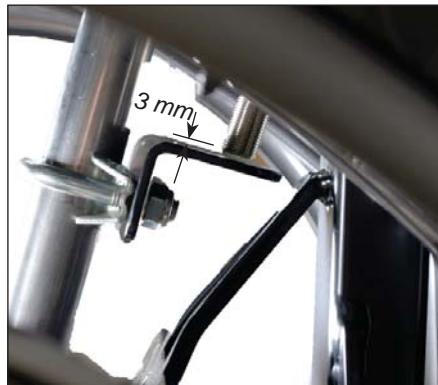
Indstilles så føleren er ca. 3 mm over pladen.
