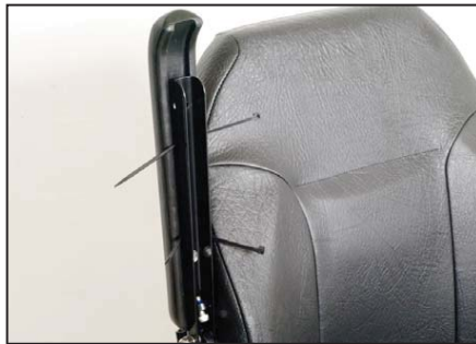
Afmontér den øverste skrue på armlænet og pres 2 strips ind til opstripsning af kabel.
