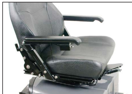
Montér stikket under sædet med stikket fra kontakten. Kontrollér at el-sædet virker som det skal.
