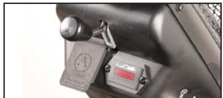
Ladestøpslet kobles til 3-polet kontakt på styrestammen. Ladekontakten er plassert under beskyttelsesplaten.
