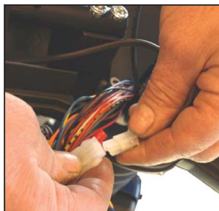
Tilslut drejegassen til det 3-polede stik, hvor standard potentiometeret var forbundet.
