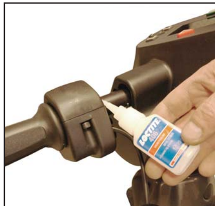
Brug loctite 406 med montering af gashåndtaget.
