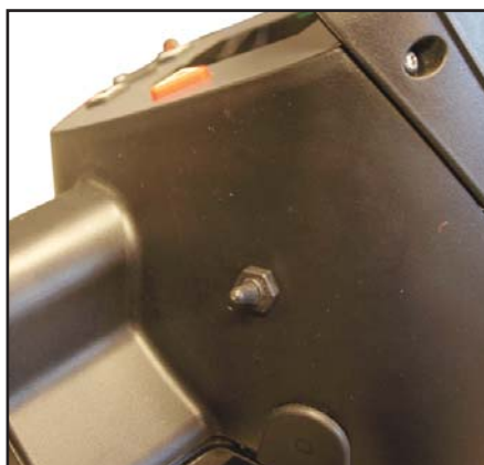
Montér kontakt så den peger til den rigtige side. Montér betjeningspanel. Undgå at klemme / strække ledningerne.
