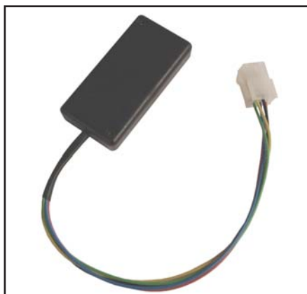
Boksen med tyverialarm, hældningsalarm og temperaturføler.
