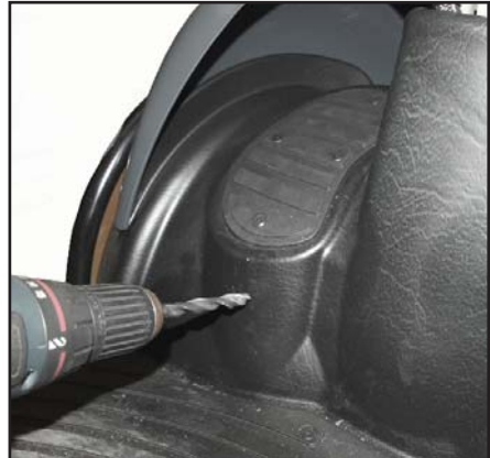
Beslut hvor fodgassen skal monteres. Bor et 13 mm hul til kablet fra fodgassen. Fores med medfølgende gummiforing.
