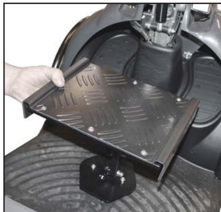
Boltes fast med de medfølgende skruer.
