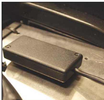
Monteres med velcro på el-pladen.
