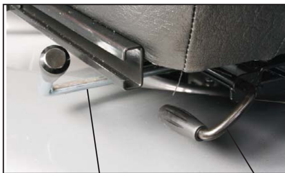
Utløserhåndtak for setedreining. Utløserhåndtak for sete frem/tilbake.
