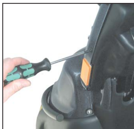
Bagerste plastskærm afmonteres v.h.a. de 6 plastskruer.
