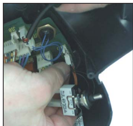
Tilslut til stik 2 på print. Montér de små crimp i stikket, så farverne matcher overfor hinanden.
