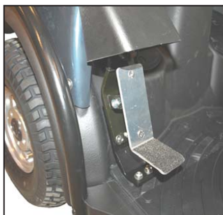
Fodgaspedalen kan placeres i højre eller venstre side, eller på midten. Programmeringen ændres til Single ended.
