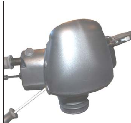
Åbn styrepanelet for at tilslutte frem/bak kontakt.
