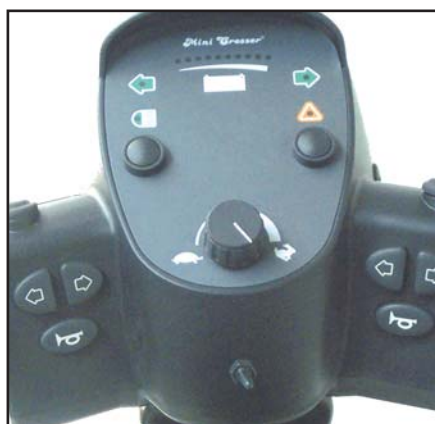
Montér betjeningspanel. Undgå at klemme / strække ledningerne.
