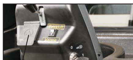
Ladestik forbindes til 3-polet stik på styrestammen. Ladestikket er plassert under beskyttelsespladen.
